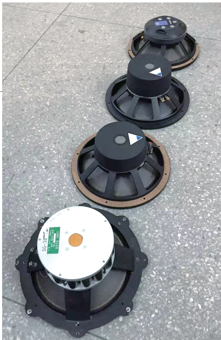
巴赫音箱设计过程中参考了几个世界知名单元，由前到后分别是GOTO SG-38WSN、TAD TL1601A、TAD TL1601B与SONY L12，目的是在性能上超越他们
